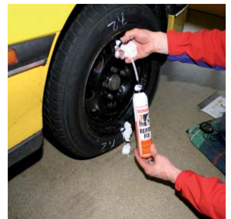
Forte fuoriuscita del mastice durante il riempimento.
