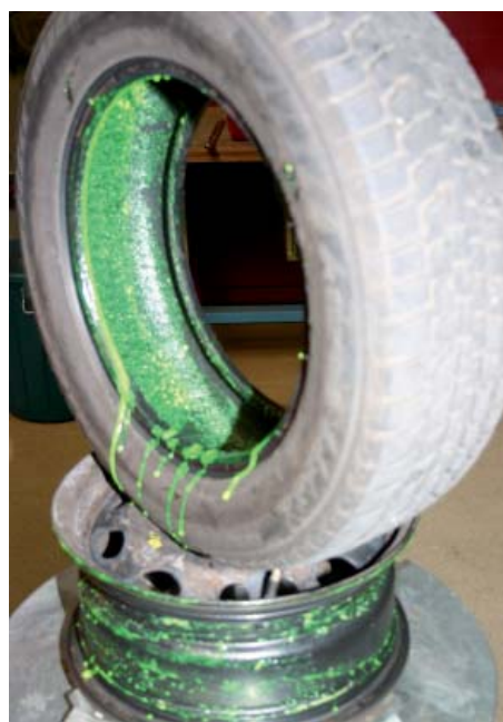
Imbarattamento forte durante lo smontaggio delle gomme.
