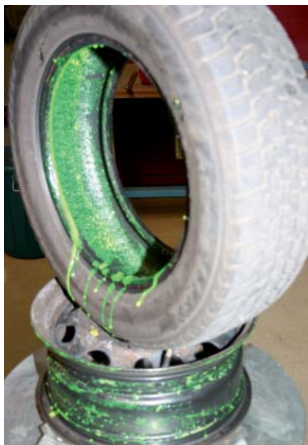
Starke Verschmutzung bei der Demontage.
